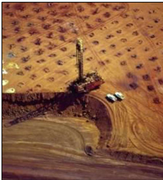
Figure 2.13 Forage des trous de mine
